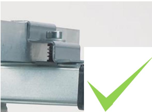
Klemme an die gewünschte Position verschieben und die Zylinderschraube mit 25 Nm anziehen. Klemmen liegen dann formschlüssig auf Modulrahmen auf.
